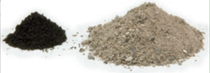
右が焼却灰、左が同量の焼却灰から生成できる熔融スラグ。その容積差は熔融前の約1/2~1/3
