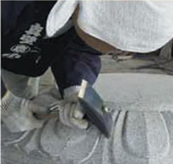
小たたき仕上げ 高級な仕上げで、刃のあとの横筋が見える
